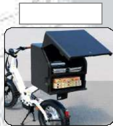
FRONTLOADER 83L Volumen: 83 L Dimenzije: 420x420x470
